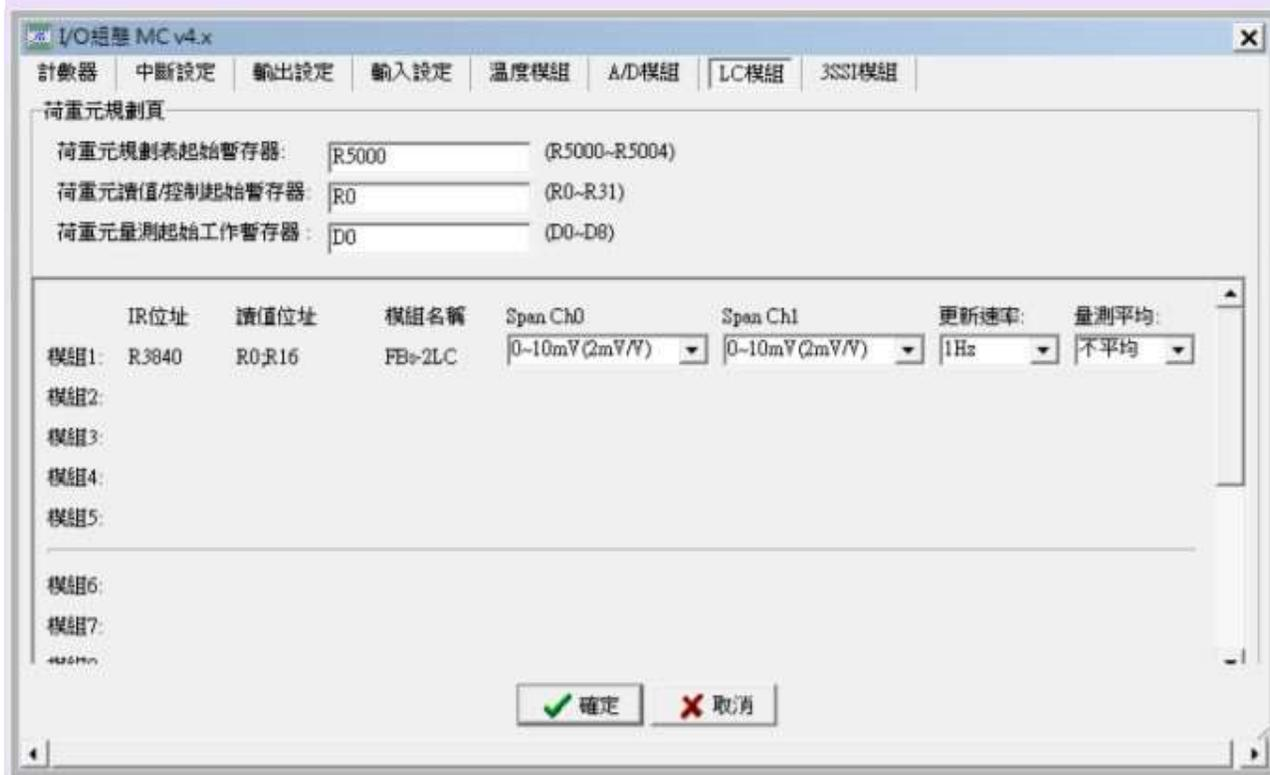
FBs-2LC 模組應用時需搭配 Winproladder 的 I/O 組態設定來進行控制.上圖是 I/O 組態設定中有關荷重元的[LC 模組]頁面內容.以下是各欄位的設定說明.
