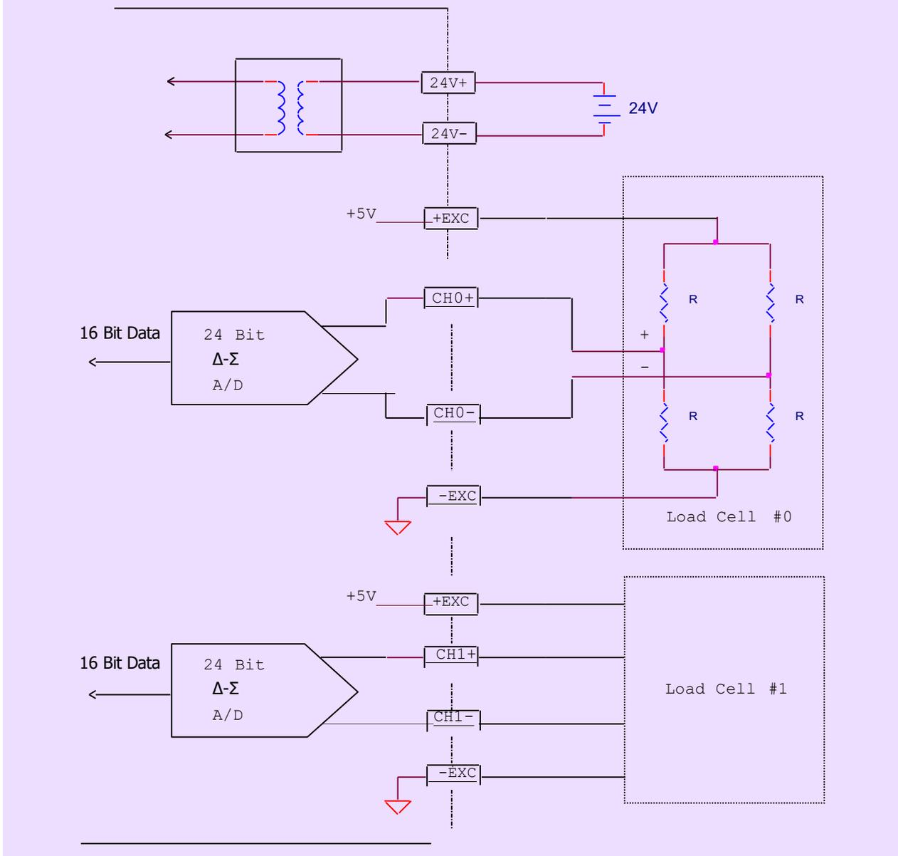
原始A/D 轉換的結果是以帶正負號的16 位元數表示.經過滿刻度參數的設定及零參考點與滿刻度點的調校程序後.系統會自動將原始的 16 位元讀值轉為對應的工程重量值.
